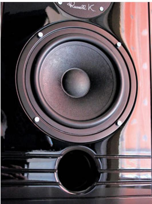
*Il cono del midwoofer ha una membrana da 130 millimetri in carta impregnata e profilo ottimizzato acusticamente.*
