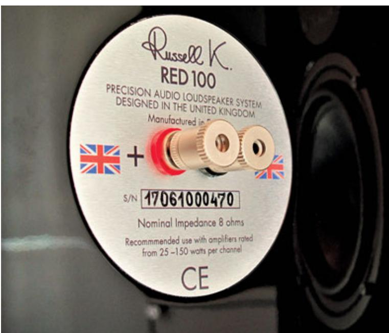
Molto ben realizzati i morsetti per i cavi, saldamente montati a ridosso del crossover.
