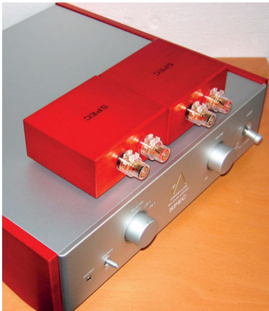
La Spec Corporation, oltre ad elettroniche (più un giradischi), ha in catalogo un "processore" di segnale. È l'RSP-901EX e si collega ai morsetti delle casse acustiche in simbiosi con i cavi provenienti dall'ampli. Il ruolo dell'RSP-901EX è quello di annullare la forza controelettromotrice prodotta dal moto del cono in funzione, migliorando la resa sonora dell'ampli. La realizzazione è molto bella.
