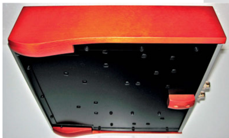
Da sotto è meglio comprensibile il profilo della struttura lignea che avvolge l'integrato, completamente sigillato, impossibile da aprire senza forzare. Un terzo elemento, sempre in legno, fornisce l'appoggio centrale posteriore.
