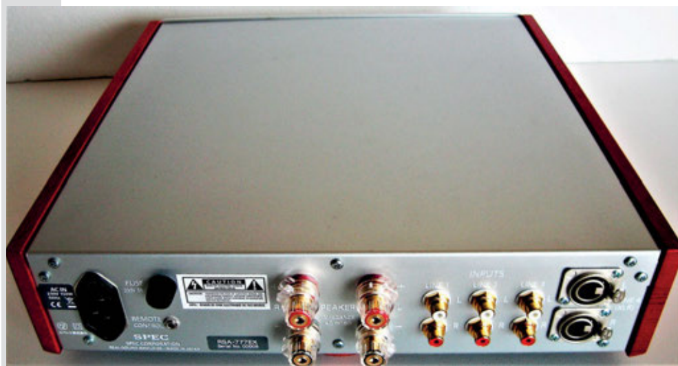
Il pannello posteriore dell'RSA-777EX è illuminante nel suo minimalismo: 1 ingresso XLR e 3 RCA, tutti LINEA. Non ci sono uscite, acustiche a parte.
