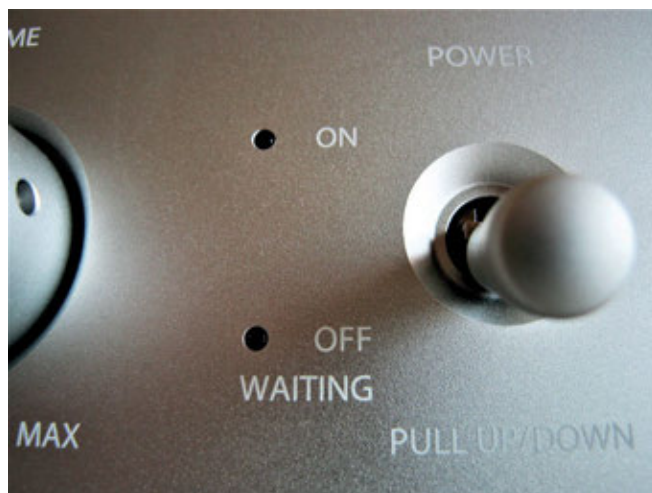
L'originalità impera in questo apparecchio: la levetta che lo attiva va tirata indietro, quindi sollevata verso l'alto. Il meccanismo è dolce e preciso, degno di una fotocamera di una volta.
