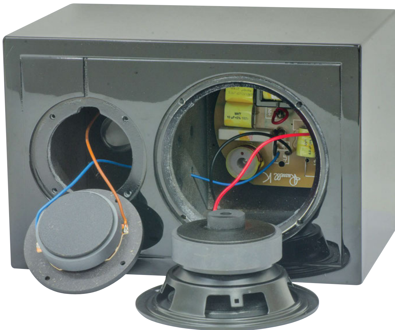
Rimosse le viti di fissaggio dalla filettatura metallica, ecco guadagnato l'interno. Notiamo la separazione tra i due volumi, il filtro crossover ed i due altoparlanti. Buono il complesso magnetico di entrambi.
